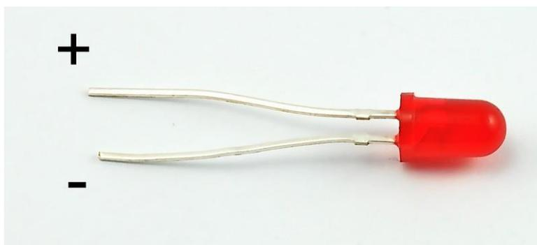
Ohne vorgeschalteten Widerstand wird die LED zerstört, da dadurch zu viel Strom durch sie fließt. Zu hoher Strom erhitzt die LED und lässt sie durchbrennen.
