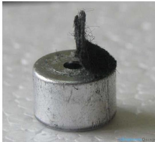
Ein festes leitendes Metallgehäuse umschließt die verschiedenen Komponenten des Mikrofons. Die Oberseite ist mit einem durchlässigen Material beklebt, das als Staubfilter dient. Die Soundsignale / Schallwellen durchdringen den Filter und bringen die bewegliche Platte zum schwingen.
