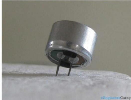
Diese Kondensatormikrofone werden in vielen Schaltkreisen verbaut, um Töne oder Luftschwingungen zu erkennen, die anschließend in elektrische Signale zur Weiterverarbeitung umgewandelt werden. Die zwei Anschlüsse im Bild oben dienen zur Verbindung mit dem Rest des Schaltkreises.
